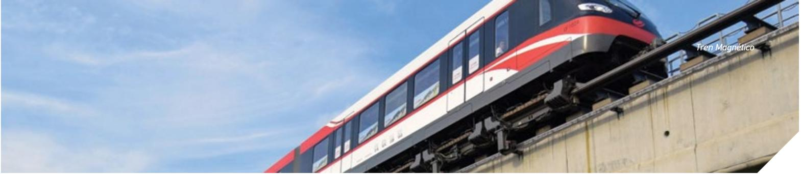
El tren de levitación magnética constituye una forma de transporte basado en la suspensión, propulsión y guía utilizando la fuerza electromagnética.
