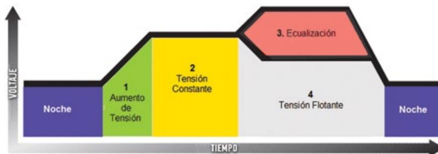
**Figura 2.** Curva de carga de baterías de ciclo profundo.
