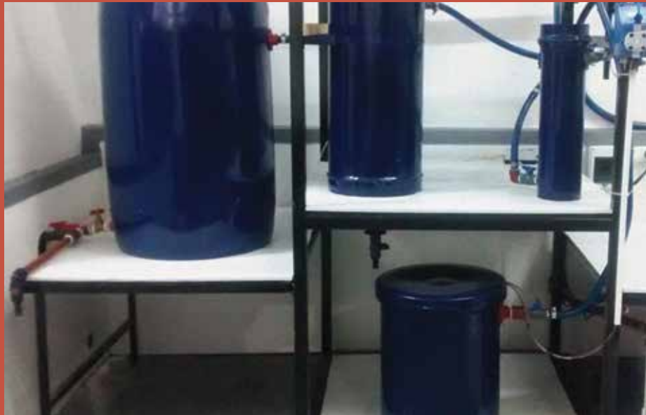
Planta de remoción de arsénico instalada actualmente en el Departamento de Hidráulica de la Facultad de Ingeniería de la UNLP.
