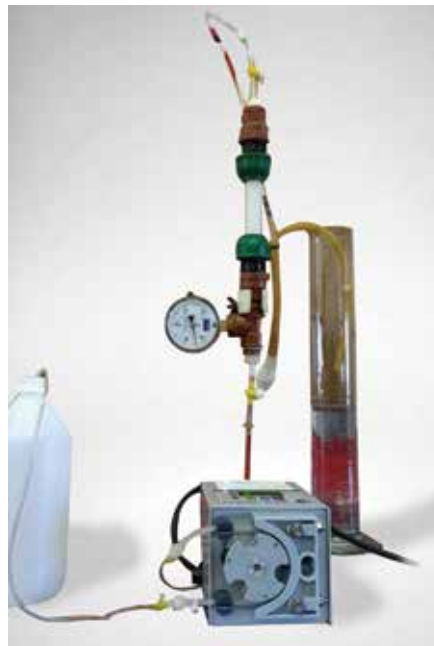
Filtro de bajo costo puesto en funcionamiento por acción de una bomba.
