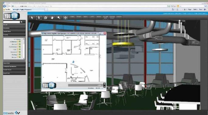
YOUBIM: Navegando el Modelo del Edificio, con acceso a los planos y datos de los elementos visualizados
