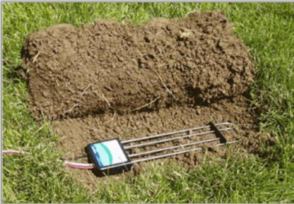
Figura 16: Ejemplo de sensor de suelo
