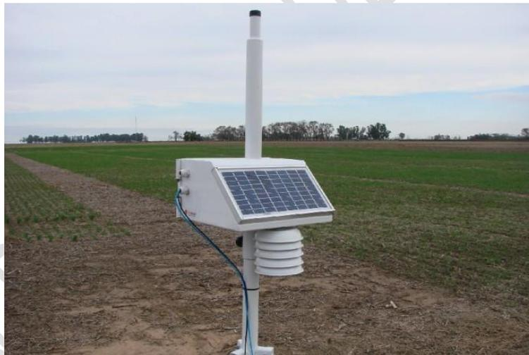
Foto: Estación telemétrica con sus sensores – J.Freites
