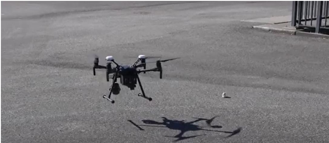
Figura 25: Dron utilizado en el puerto de Hamburgo para inspeccionar estructuras
