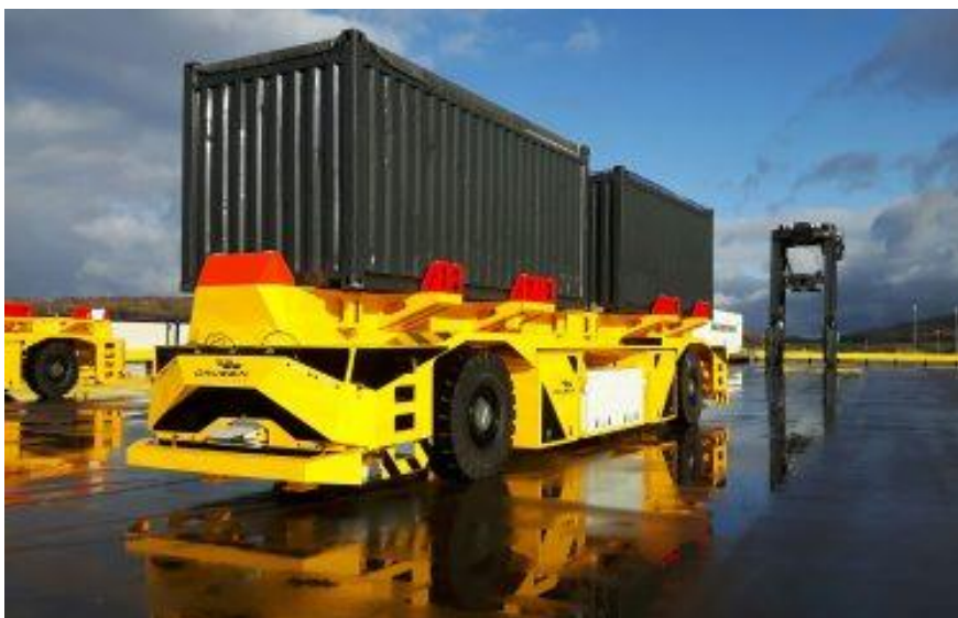
Figura 10: Camiones portacontenedores autónomos
