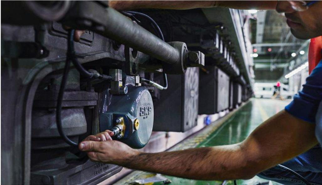
Instalación del IMx-Rail en el bastidor del bogie
