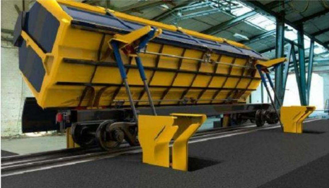
Consiste en unidades que permiten transportar cualquier tipo de carga a granel, incluso contenedores; también se previó que el contenedor del vagón tenga un proceso de descarga lateral y sea extraíble, lo que facilitaría que pueda cambiarse por una plataforma. Asimismo que pueda adaptarse al ancho de vía internacional, que sea de un material más ligero para reducir peso y que tenga más capacidad de carga, además de disponer de un sistema de lavado más rápido y económico.
