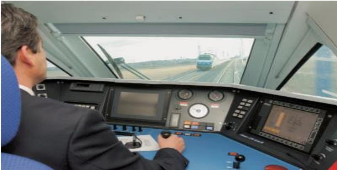
Los trenes de alta velocidad tienen los sistemas de señalización en cabina. El nuevo sistema ERTMS de nivel 2 envía la información de los enclavamientos por radio empleando la red GSMR. (Foto: Cabina del Talgo de alta velocidad serie 102. M.A.Patier Renfe)
