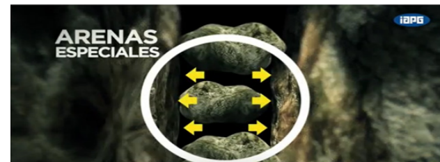
Gráfico 11. Arena dentro del interior de las fisuras.
