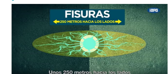
Gráfico 8. Radio de fisura.
