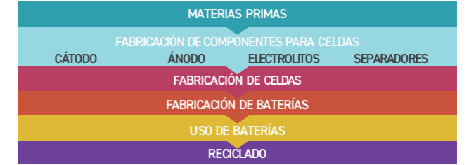
Gráfico45. Cadena de valor simplificada en la fabricación de baterías
